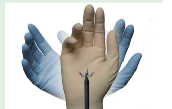
体内に挿入する鉗子は柔軟な操作ができるように関節を備えており、人の手よりも広範囲に稼働します。
