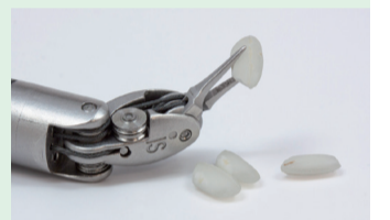
精密な動作を可能にする鉗子。つまむ、はがす、切る、縫う等コントローラーの操作に連動して正確に動きます。
